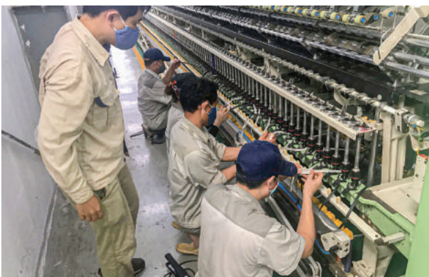
Lắp đặt dây đai, băng tải tại Nhà máy Dệt Sợi Installing belts and conveyors at the Textile Factory
