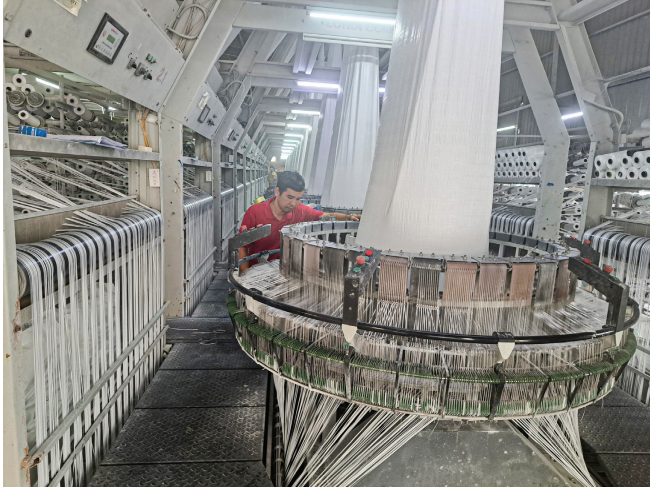
Khảo sát máy dệt PP PP Circular loom inspection
