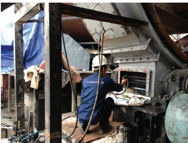
Phun dầu sửa chữa vành răng hở Repair lubrication spray service
