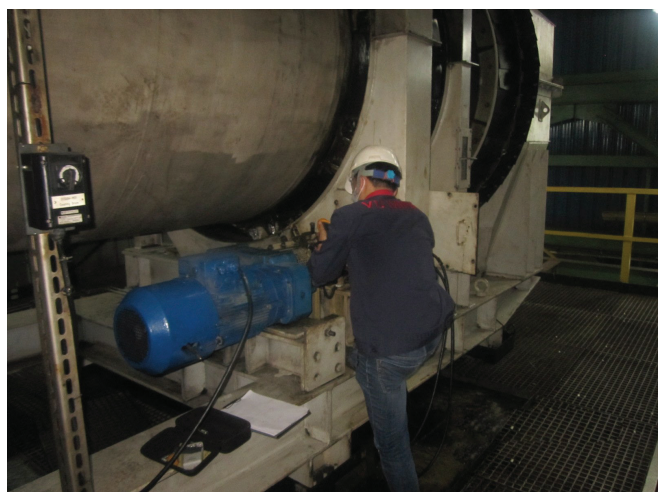
Đo kiểm tra và căn chỉnh vành răng hở Open gear inspection and adjustment
